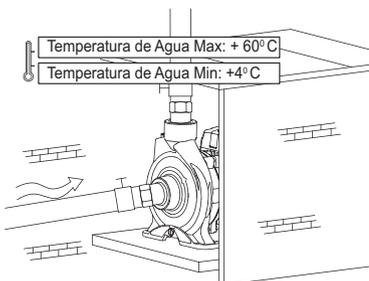
1. La tubería de succión debe ser tan corta y con el menor número de codos como sea posible. La bomba debe ser instalada en un lugar seco y ventilado. Si se instala en ambientes externos debe cubrirse apropiadamente de la lluvia y el viento. Coloque la bomba en una superficie plana sólida usando los pernos adecuados para evitar vibración. La bomba debe instalarse en posición horizontal para asegurar que los cojinetes funcionen correctamente.
