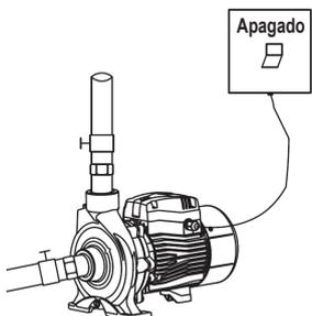
7. Si el líquido bombeado esta presurizado y/o caliente, antes de mover y desmontar la bomba, cierre las válvulas de entrada y salida de la bomba, luego vacíe el líquido de la bomba y tuberías para evitar quemaduras.
