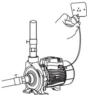
9. Asegúrese que la electrobomba no se arranque accidentalmente mientras se instala o se le hace mantenimiento. Si la bomba se va a dejar de usarse por largo tiempo, corte el suministro eléctrico y luego cierre las válvulas de entrada y salida de la bomba.
