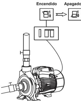
2. La electrobomba debe tener una conexión a tierra confiable para prevenir corto circuito; por seguridad la conexión eléctrica debe estar protegida de humedad y goteo.
