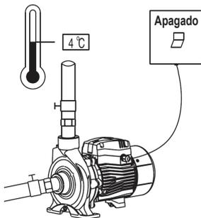
6. En caso que la temperatura ambiente este por debajo de 4°C ó que la bomba tenga que dejar de usarse por largo tiempo, vacíe el líquido de la tubería para evitar congelamiento dentro de la bomba. **NO OPERE LA BOMBA SIN AGUA.**
