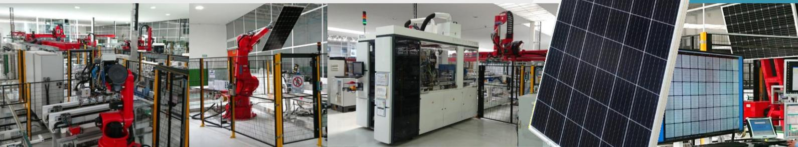
Panel fotovoltaico de Alta Eficiencia de 72 celdas M3 de silicio monocrystalino 5BB que mejora el desempeño del módulo; tecnología PERC con la cual se logra una mayor captación de la luz solar logrando generar más electricidad y obteniendo una mejora en la capacidad de producción. Con vidrio templado antirreflejante de 3.2 mm, caja de conexión IP68 con 3 diodos bypass y conectores compatibles con MC4.
